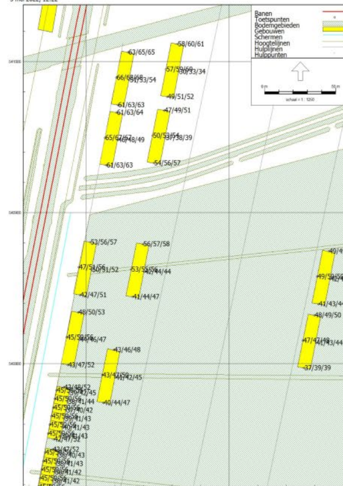
Woningbouw langs spoor te Beilen met extra geluidscherm Lden railverkeer met scherm - I 5 mei 2022, 12:22
